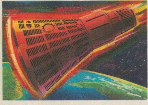
**Mur de chaleur.** La rentrée de la capsule dans l'atmosphère provoque un échauffement de 1400°C qui fait passer du rouge au blanc les parois protectrices. A ce moment critique, le pilote pèse une tonne.
